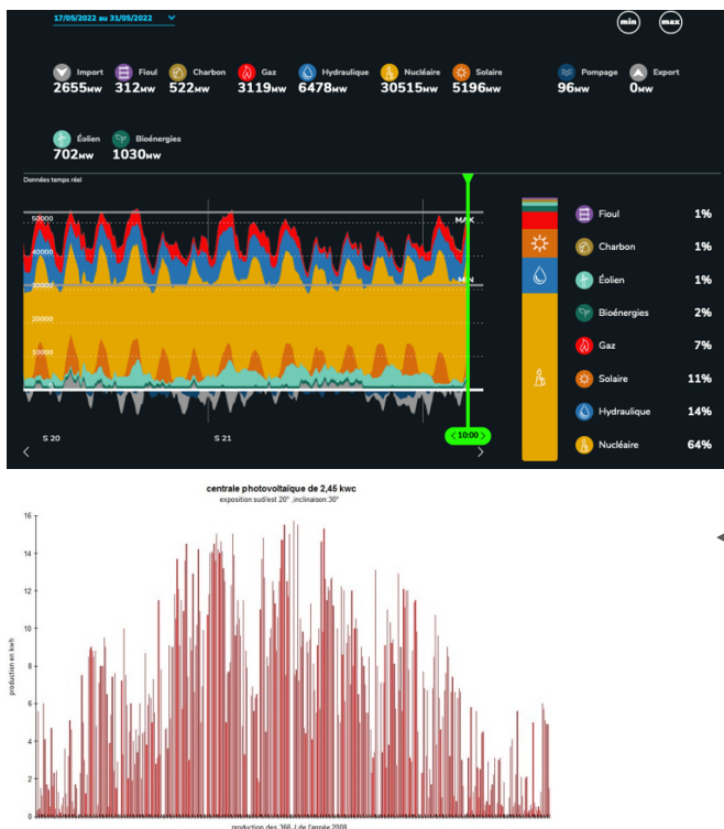
Figure 54 : Courbes de consommation et production d’électricité en France du 17 au 31 mai 2022 – source RTE ECO2MIX
